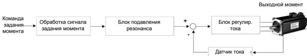
На приведенном рисунке показана блок-схема обработки сигнала задания момента, описание которого было дано в разделе 6.4.1, включая ограничение задания момента аналоговым сигналом (P1-41) и способ повышения плавности работы в режиме управления моментом. На блок-схеме контура тока показаны параметры коэффициентов усиления и способ формирования сигнала подаваемого на серводвигатель. Сервопривод имеет только входные параметры.
