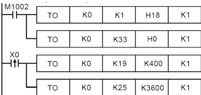
При замыкании M1002 в модуль с номером «0» записывается в регистр CR#1 значение H18, тем самым устанавливая для канала 2 Режим 3, т.е. – 20 мА ~ + 20 мА.
