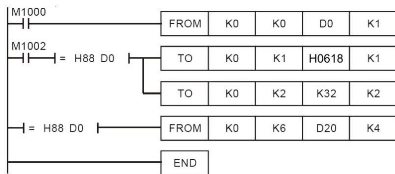
При замыкании M1000 происходит чтение кода типа модуля с целью удостоверится, что это DVP04AD-S. Его код H88.
