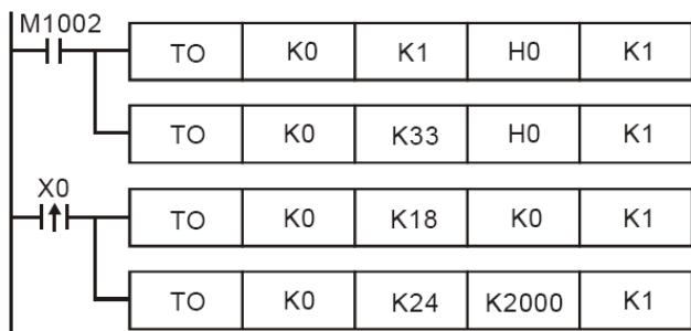
При замыкании M1002 в модуль с номером «0» записывается в регистр CR#1 значение H0, тем самым устанавливая для всех каналов Режим 0, т.е. – 10 В ~ + 10 В.
