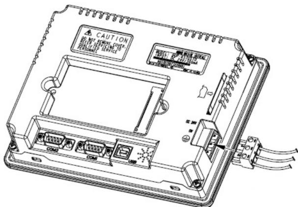
В качестве соединителя используется стандартный разъем DB9, и только у панелей DOP-AS используется на COM2 и COM3 винтовой клеммник.
