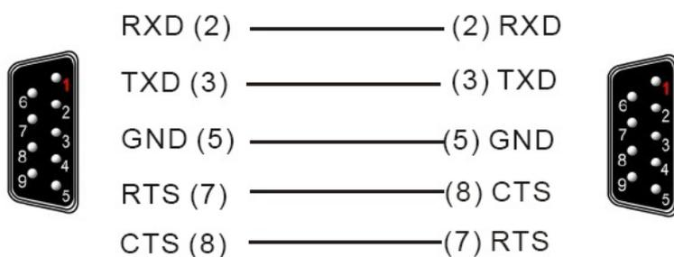
При работе через COM2 и COM3 в 3-х проводном режиме RS232 в переходнике необходимо перемкнуть контакты 7 и 8 в обоих разъемах:
