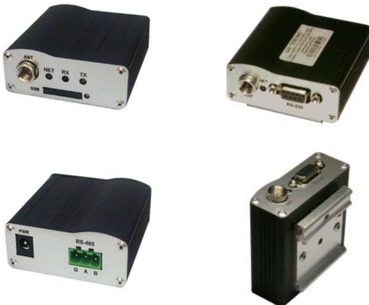
Если предполагается подключать GSM-модем к панели оператора DOP-A+ по COM1 RS232, то необходимо спаять переходник, так как и модем и панель имеют разъемы DB-9F (мама).
